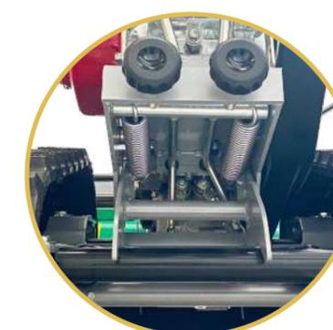
**Compensatori di carico** sull'assale posteriore in funzione delle varie pendenze; garantendo la massima aderenza in ogni condizione di lavoro.
