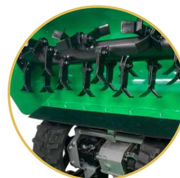
**Rotore con quattro sezioni** di coltelli sfalsati in acciaio per ottimizzare la lavorazione e minimizzare l'assorbimento di potenza del motore, garantendo, quindi, un minor consumo.
