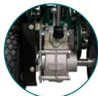
**Cambio in alluminio Made in Italy** con due marce avanti, estremamente resistente alla corrosione e alle sollecitazioni.
