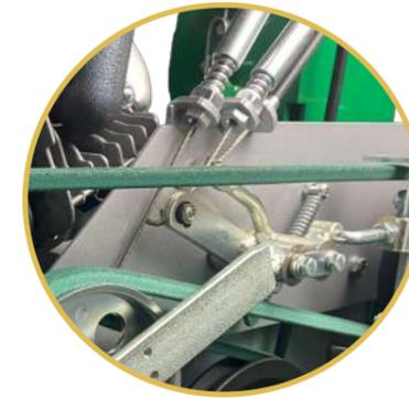
**Spannungskompensatoren** für die automatische Einstellung des Riemenspanners zur Vermeidung von Riemenschlupf. Dies ermöglicht eine bessere visuelle Kontrolle der Einstellung der Spanner.
