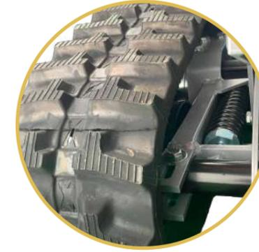
**Automatische Raupenspannung** dank speziell entwickelter Federn.
