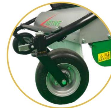
**Vordere Vollgummiräder** auf Stahlfelge, komplett mit Lenkradsperre.
