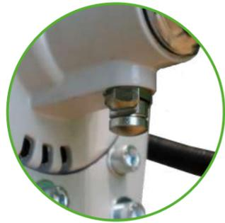
Ein **praktischer Entriegelungsstift** ermöglicht das sekundenschnelle Lösen der flexiblen Welle vom Motor.
