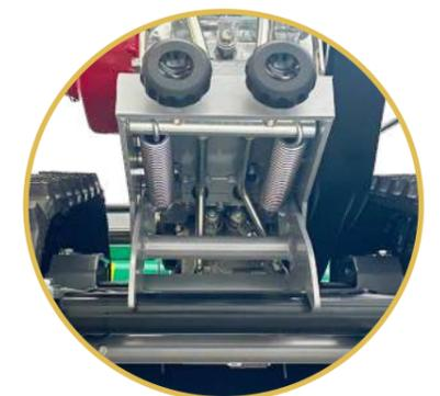
**Lastkompensatoren** an der Hinterachse für die verschiedenen Steigungen, um unter allen Arbeitsbedingungen maximale Bodenhaftung zu gewährleisten.
