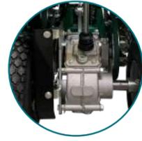
Getriebe aus Aluminium Made in Italy mit zwei Vorwärtsgängen, extrem korrosions- und spannungsbeständig.
